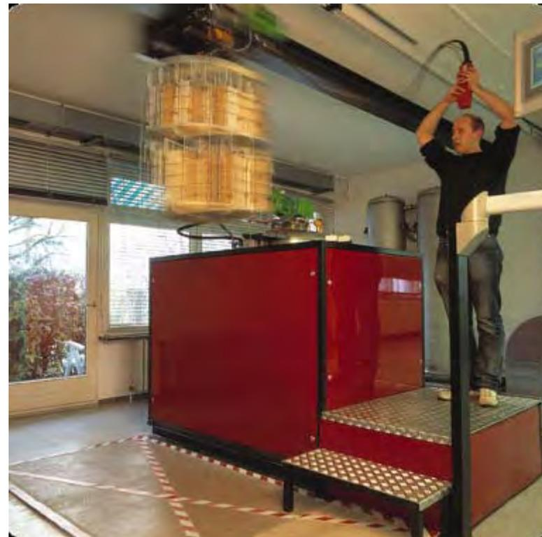
3. Installation des ouvrages dans l'autoclave
