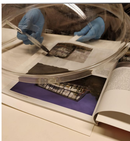
Figure 1 décollage d'une feuille de papier couché à l'aide d'un pinceau à recharge rempli de solvant et d'une spatule téflon, sous hotte aspirante mobile
