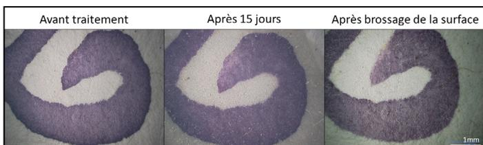
**Figure 7** - Images en microscopie HIROX de l'échantillon ; 1-Avant traitement, 2-Après traitement pendant la sublimation du cyclododécane, 3-Après sublimation et brossage de la surface ©BnF.
