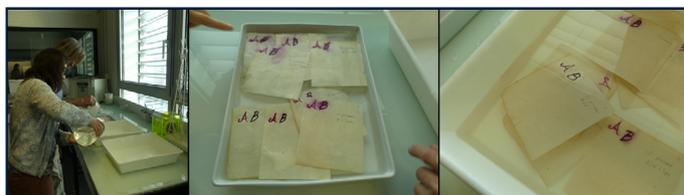
**Figure 5** - Réalisation des bains propres au phytate de calcium sur des éprouvettes de test pour la stabilisation des encres ferrogalliques ©BnF.
