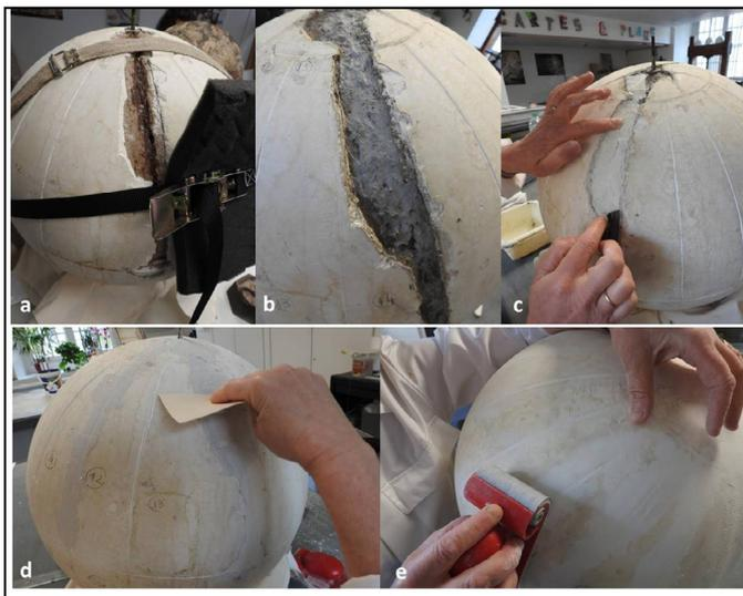
**Figure 20** – Redressement, consolidation du globe a) ceinturage du globe terrestre, b) consolidation avec un mélange de pulpe de carton et de Planatol® 152, c) pose de bandes plâtrées, d) lissage au blanc de Meudon, e) ponçage ©BnF.
