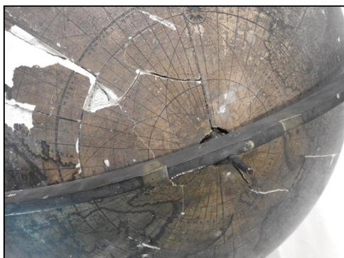
**Figure 5** - Réseau de cassures profondes au niveau du pôle Nord du globe terrestre ©BnF.
