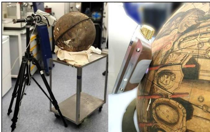
**Figure 8** - Analyse par spectrométrie de fluorescence de rayons X (XRF) sur le globe céleste ©BnF.
