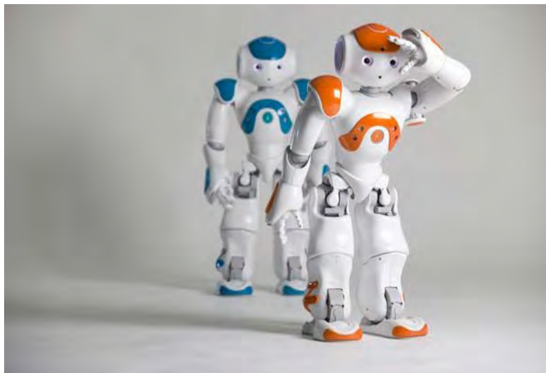
Robot humanoïde Nao, autonome et programmable, mesurant 58 cm. Il a été conçu et fabriqué en France.
