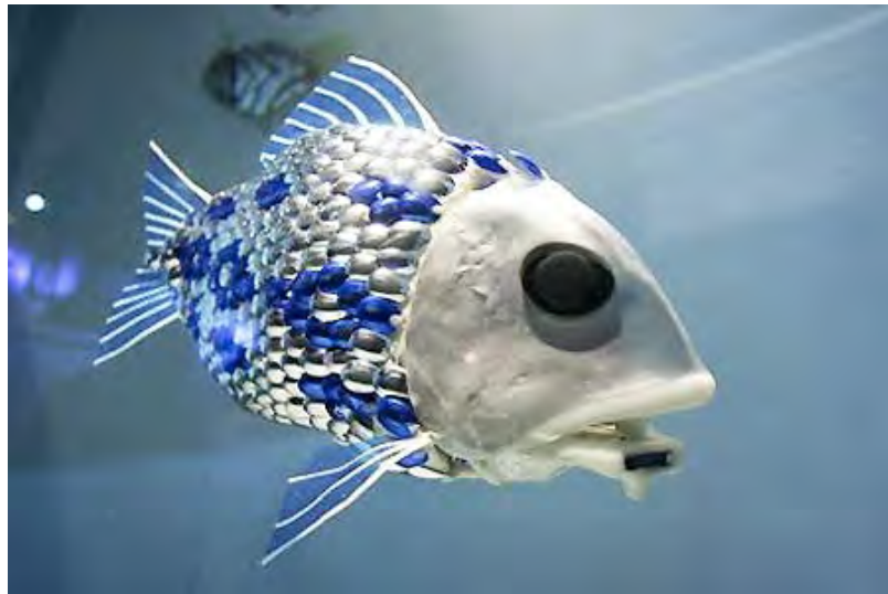
Prototype de poisson-robot capable d'identifier, d'analyser et de transmettre les informations sur une source de pollution.
