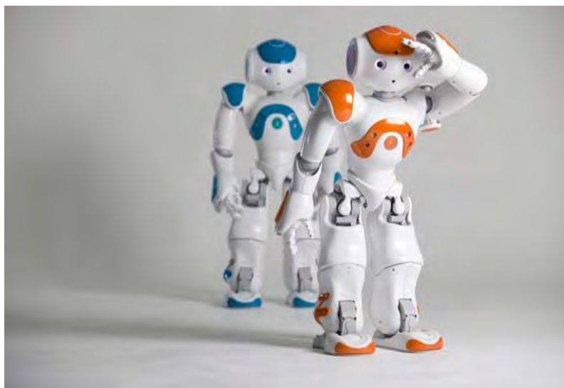
Robot humanoïde Nao, autonome et programmable, mesurant 58 cm. Il a été conçu et fabriqué en France.
